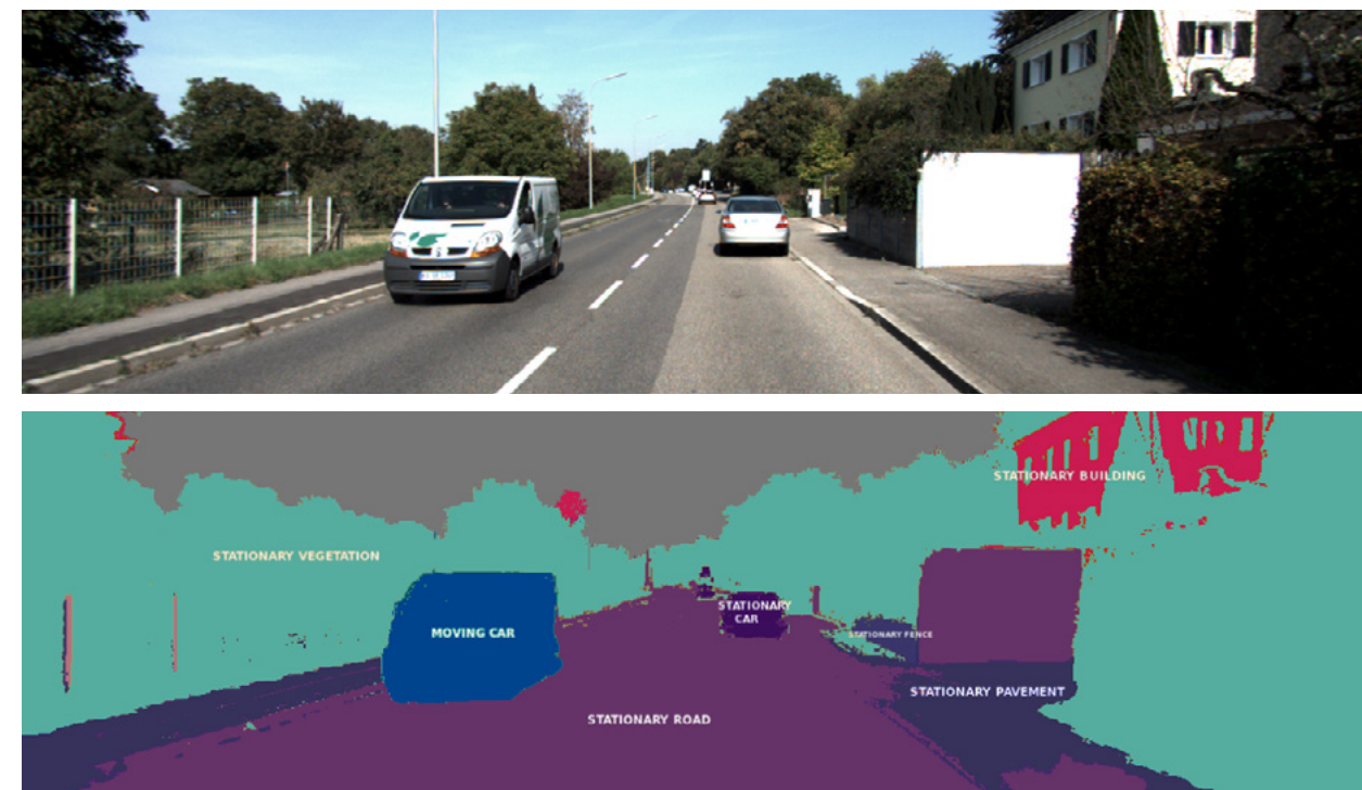
Slika 1. Primer isečka iz videa u kom su obeleženi relevantni objekti (put, vozilo). https://raw.githubusercontent.com/deetungsten/website-images/master/ml/segmanticexample.png
